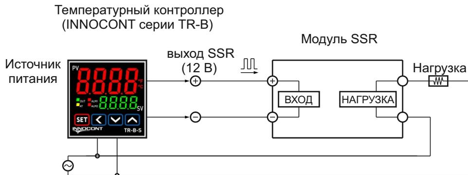
В случае выбора режимов фазового и циклического регулирования **необходимо использовать один источник питания для нагрузки и температурного контроллера.**
