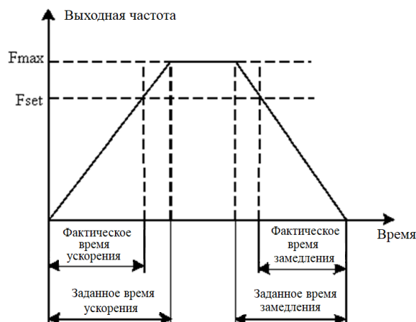
Рис. 6-2 Схема времени ускорения/замедления
