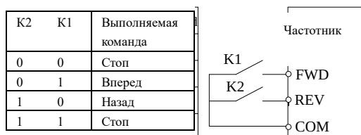
Рис.6-13 Двухпроводной режим управления 1
