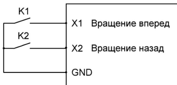
Рис. 5-11 Принципиальная схема двухпроводного режима работы
