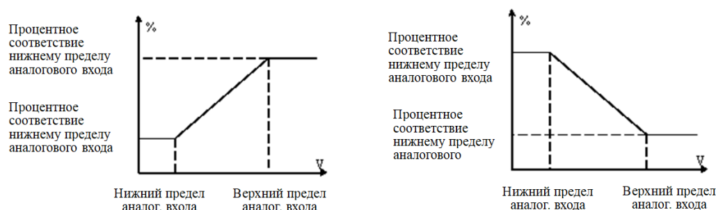
Рис. 6-18 Линейная кривая аналогового входа
