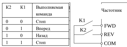
Рис.6-13 Двухпроводной режим управления 1
