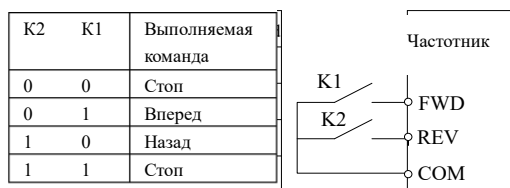
Рис.6-13 Двухпроводной режим управления 1
